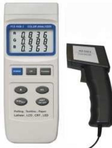
Mjerač boje RGB-1002 (Senzor za boju priključen sa 1,5 m kablom na mobilni zaslon)
