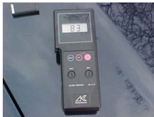
Ovdje vidite izmjerenu veličinu na zaslonu glasimetra.
