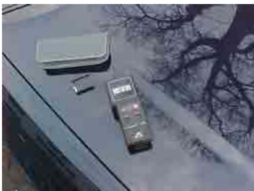
Ovdje vidite glasimetar IG-310 kod mjerenja na lakiranoj površini.
