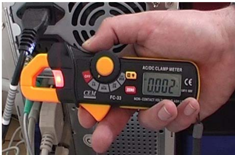
Mini – strujna kliješta FC-33 kod beskontaktnog mjerenja u kابلu
