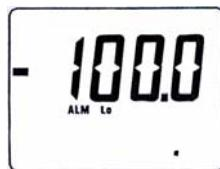
Pritisnite tipku ▲ ili ▼ dok se u displayu pokaže dolnja alarmna granica koju želite postaviti. Nakon toga pritisnite tipku „ENTER“ za memoriranje ove vrijednosti. Nakon toga možete podesiti doljnju alarmnu granicu. Display pokazuje „ALM LO“.
