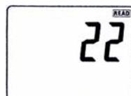
Protisnite tipku ▲ ili ▼ i očitajte pohranjene vrijednosti. Ponovnim pritiskom tipke „READ“ napuštate ovaj modus.
