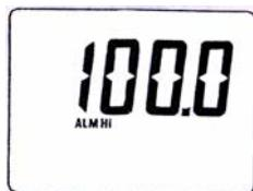
Pritisnite tipku ▲ ili ▼ dok se u displayu pokaže gornja alarmna granica koju želite postaviti. Nakon toga pritisnite tipku „ENTER“ za memoriranje ove vrijednosti. Nakon toga možete podesiti doljnju alarmnu granicu. Display pokazuje „ALM LO“.
